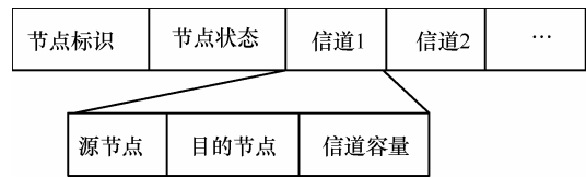
图 2 随机线性网络编码的数据分组格式
